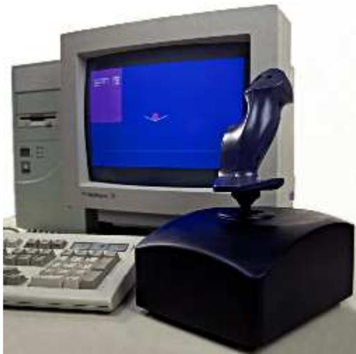
Abbildung 9: Force-Feedback-Joystick
