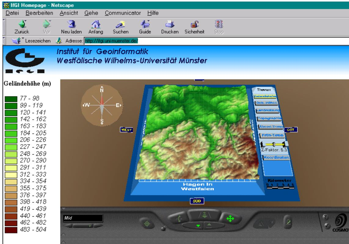
Abbildung 19: Cockpit-Widget in einem verbreiteten VRML-Viewer (CosmoPlayer) zur Navigation durch 3D-Szenen. Die Szene enthält Tasten zur Themen-Auswahl und einen Schieberegler zur Einstellung der Überhöhung
